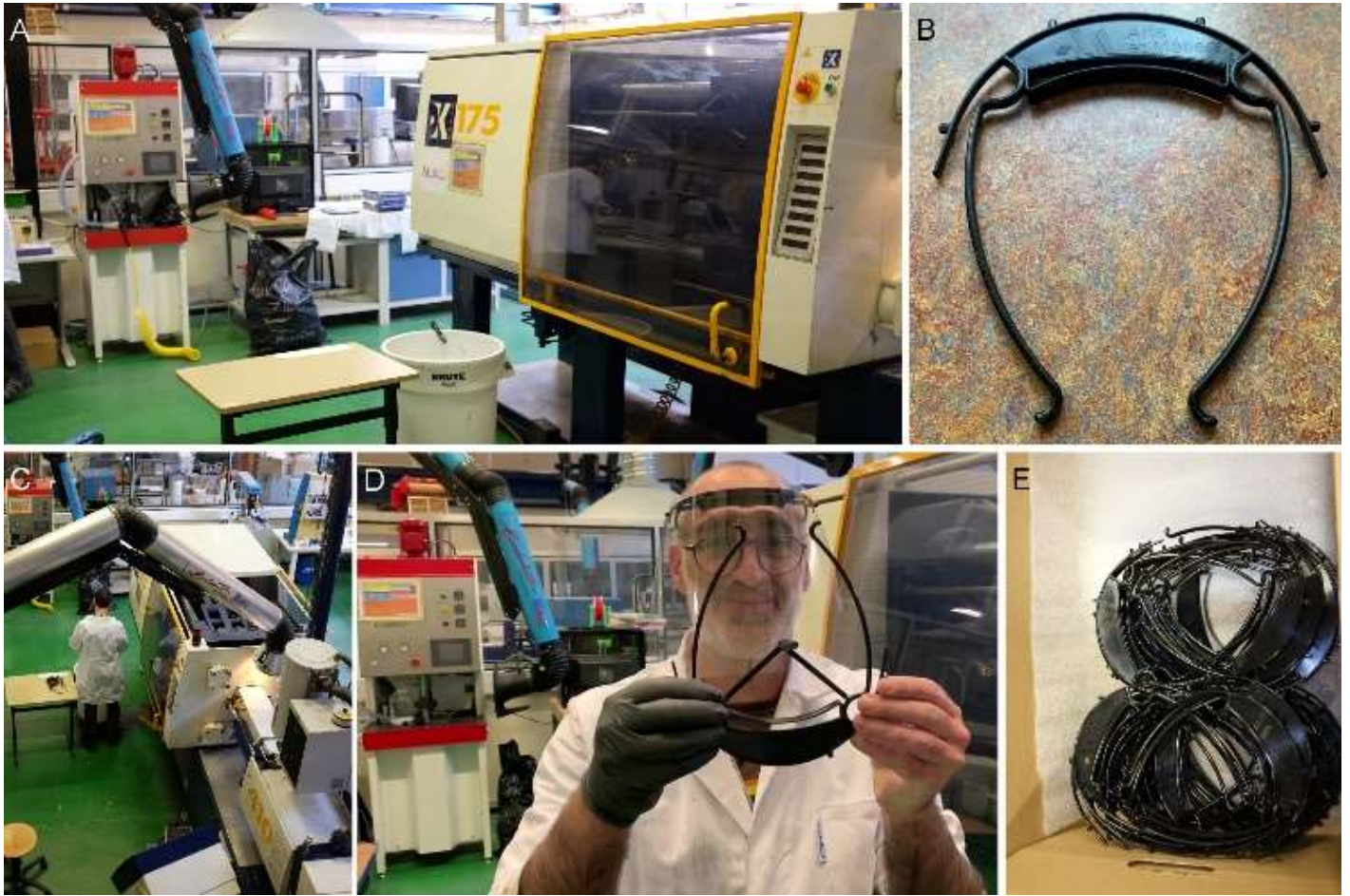
Figure 9 : Mise en œuvre de la production. A- Machine d'injection du PIMM des Arts et Métiers. B- Serre-tête injecté en PA6 C- Séance de production par les équipes de recherche du PIMM. D- Masque posé sur le visage. E- Production horaire de visière.
