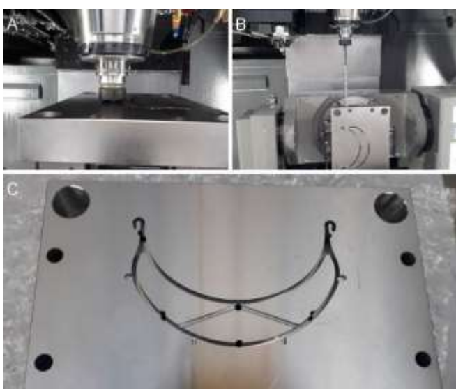
Figure 3 : Empreinte du moule usiné sur le campus Arts et Métiers de Bordeaux. A-B Etapes d'usinage du moule. C Empreinte finale du moule
